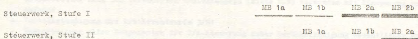
Bild 3.2: Überlappter Durchlauf im Steuerwerk, Taktphase 250 ns
